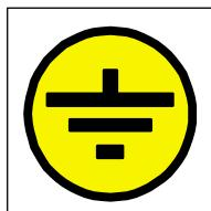
Выполните заземление фильтрующего оборудования согласно нормам вашей страны. Гибким медным проводом сечением 10  $\text{мм}^2$  подключите фильтрующее оборудование к заземлению.
