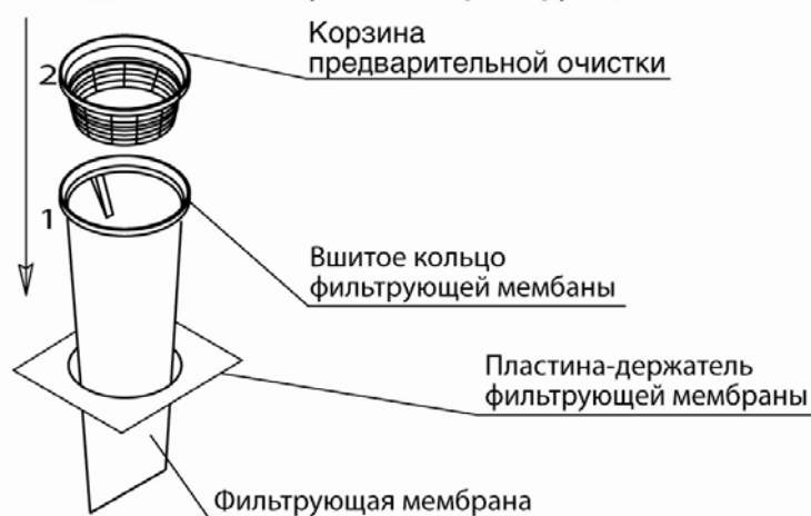
Последовательность установки фильтрующих элементов
